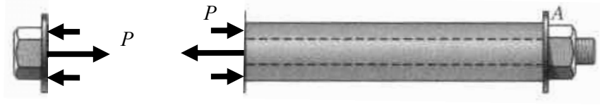
Figure 9. DCL de l'écrou et de l'ensemble boulon-manchon.
